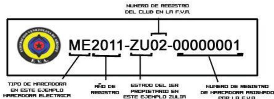
La etiqueta de identificación y registro deberá ser colocada en la parte baja del cuerpo de conjunto de accionamiento conforme al gráfico siguiente:
